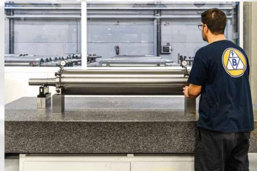
Nuestro patentado Optical Fluting Test es el único dispositivo en el mundo que mide el perfil de las estrias por medición óptica.
