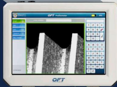
Nuestro patentado Optical Fluting Test es el único dispositivo en el mundo que mide el perfil de las estrías por medición óptica.
